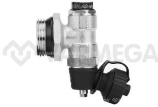
Конечный элемент коллектора предназначен для установки на коллекторные блоки систем напольного отопления или радиаторного отопления. Выполняют функцию ручного удаления воздуха. Также с помощью дренажного крана можно заполнить/слить теплоноситель из системы.
