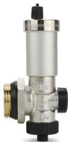
Конечный элемент коллектора предназначен для установки на коллекторные блоки систем напольного отопления или радиаторного отопления. Выполняют функцию автоматического удаления воздуха. Также с помощью дренажного крана можно заполнить/слить теплоноситель из системы.
