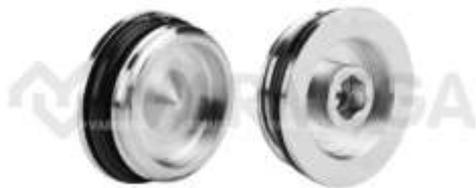
Латунная никелированная заглушка (пробка) с наружной резьбой используется для герметичного закрытия неиспользуемого присоединительного отверстия коллектора диаметром 1". В заглушке есть головка-шестигранник под гаечный ключ. Уплотнительное кольцо выполнено из EPDM.
