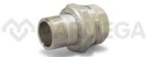
Разъемное (разборное) соединение "американка" Varmega является одним из самых востребованных резьбовых фитингов. Конструктивно разборное соединение состоит из следующих элементов: быстроразъемной шестигранной гайки с резьбой, двух резьбовых фитингов, а также прокладки (паронитовой или эластомерной). В некоторых видах "американок", например с конусным присоединением, прокладка не используется.
