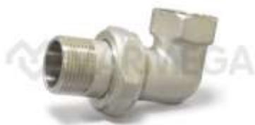
Разъемное (разборное) соединение "американка" Varmega является одним из самых востребованных резьбовых фитингов. Конструктивно разборное соединение состоит из следующих элементов: быстроразъемной шестигранной гайки с резьбой, двух резьбовых фитингов, а также прокладки (паронитовой или эластомерной). В некоторых видах "американок", например с конусным присоединением, прокладка не используется.
